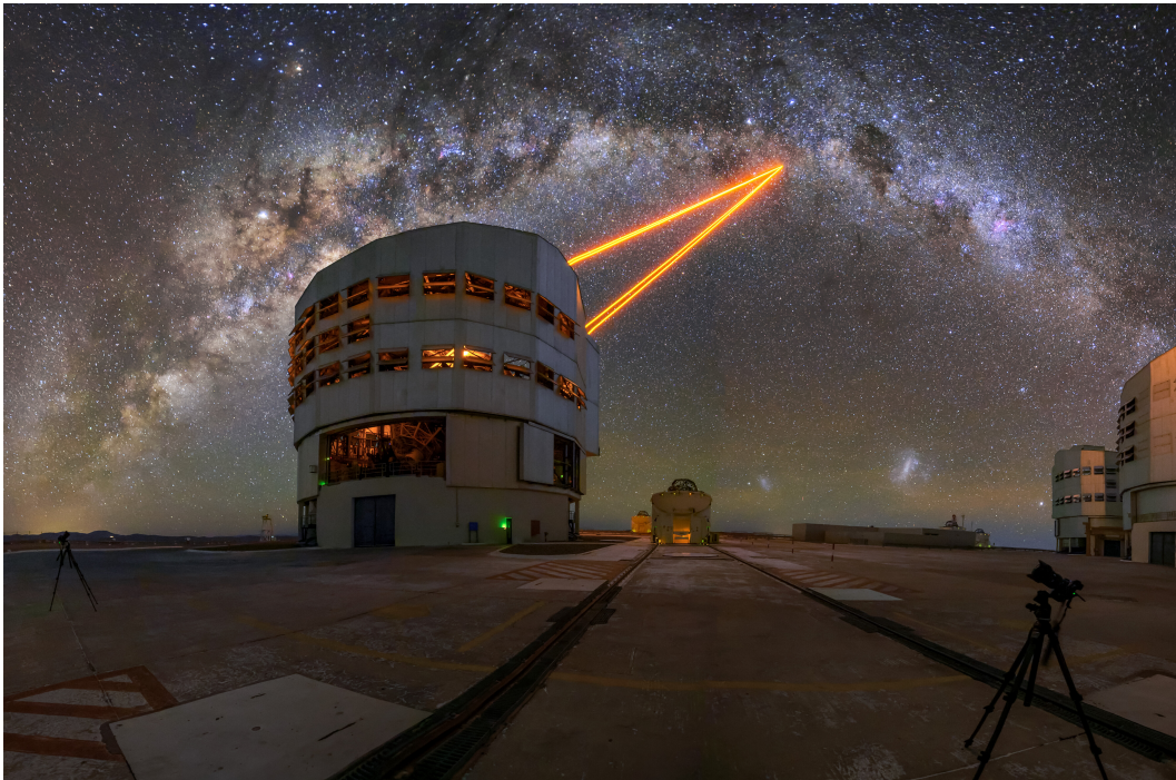
Obrázek 52: Dalekohled Yepun (VLT) na observatoři Paranal vytváří pomocí čtyř laserových svazků referenční hvězdu (laser guide star) [E33].
