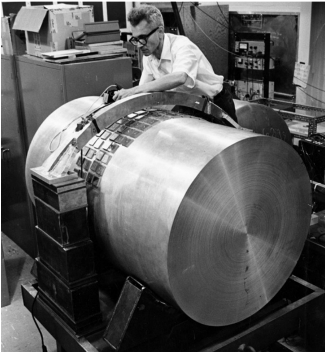
Obrázek 91: Joseph Weber a jeho rezonanční detektor gravitačních vln ( Weber 1969 ).
