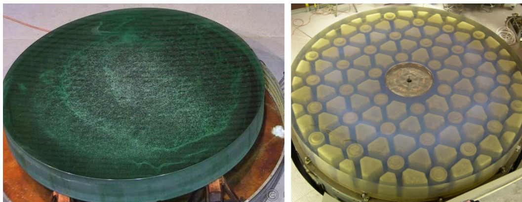
Obrázek 49: Srovnání zrcadel Hookrova (vlevo [E30]) a Haleova dalekohledu (vpravo [E30]). Zrcadlo Hoorkova je zhotoveno ze zeleného lahvového skla a má 4,5 tuny, zrcadlo Haleova dalekohledu pak z pyrexu a díky žebrování má jen 14,5 tuny.
