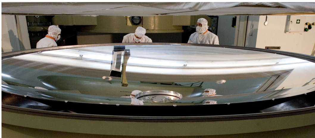
Obrázek 54: Aluminizace primárního zrcadla Herschlovy vesmírné observatoře [E35].
