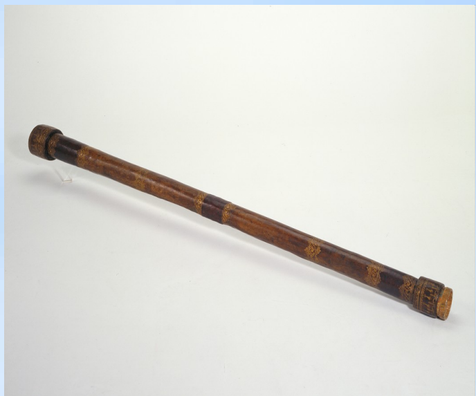
Gallieův dalekohled ( D=37\text{mm} , f'=980\text{mm} , \Gamma=20\times ) Galileo Galilei (1564-1642)
