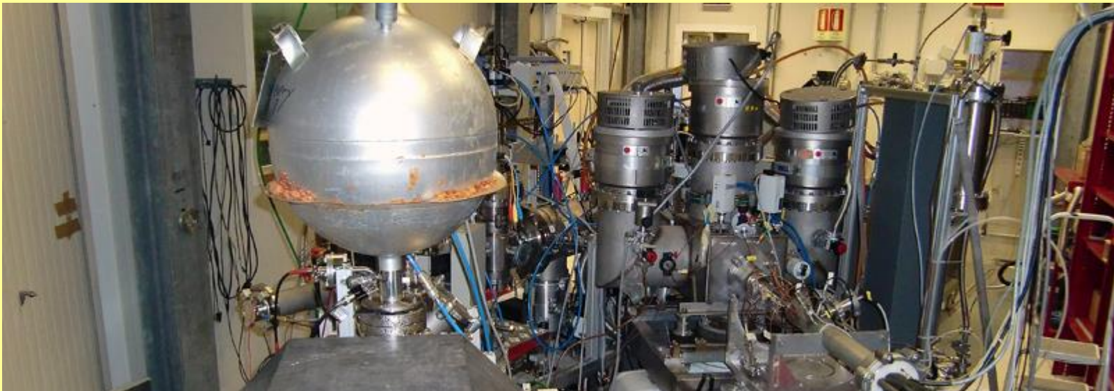
Elektrostatický lineární urychlovač s napětím 400 kV
