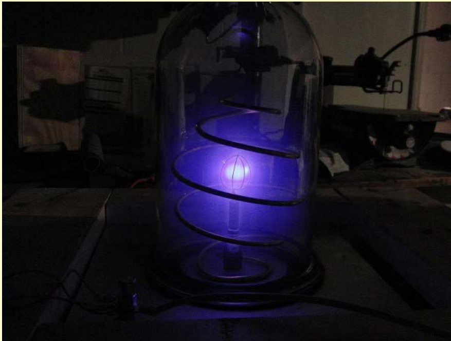
Fúzor využívá elektrické pole pro urychlení iontů pro překonání coulombovské bariéry
